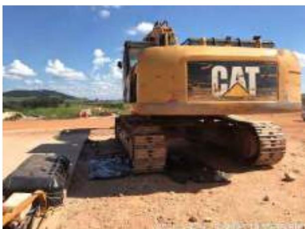
**Foto 89** – Equipamento em manutenção emergencial com isolamento do solo. (Data:25/03/2021)
